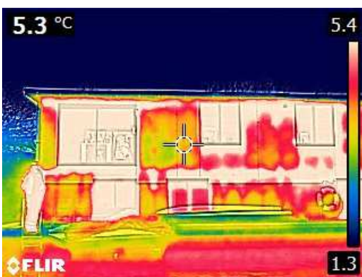
Een minder goed geïsoleerde woonark, let op het verschil tussen het oude dubbelglas en het nieuwe HR++ raam onder in het midden.
